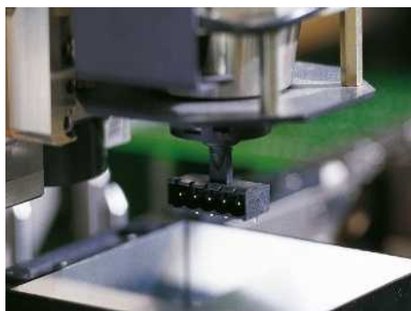
Регистрация данных при помощи камеры для снятия размеров компонента
