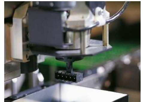
Компонент на монтажной головке
