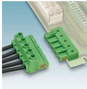
Серия HC: винтовые разъемы, до 16 А, шаг 7,62 мм, допуск UL на применение в цепях на 600 В GIC 2,5 HCV... Стр. 503
