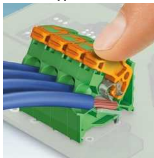
Серия PLH 5: пружинные зажимы Push-Lock, шаг 7,5 мм, до 41 А подключение: под углом 30° к печатной плате PLH/A 5... Стр. 470
