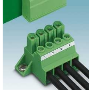
Серия PC 6: штекерные части для непосредственного крепления, винтовые зажимы, до 41 А, шаг 10,16 мм PCU 6/... Стр. 552
